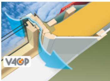
Вентклапан с пропускной способностью до 49 м<sup>3</sup>/час, позволяющий оптимизировать приток свежего воздуха в помещение и значительно сократить теплопотери за счет автоматического частичного закрывания при высокой разнице давления.
