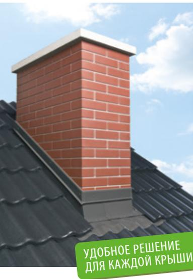
**Оклад GZK** предназначен для герметичного соединения дымовой трубы с кровельным покрытием, облегчает монтаж и сокращает время работы. Оклад **GZK-AV** подходит к трубам с шириной до 95 см и высотой до 180 см (размер измеряется по поверхности крыши). Верхний и нижний элементы оклада регулируются, а боковые можно подрезать под необходимые размеры. Устанавливается в кровле с углом наклона от 15° до 70°.
