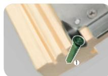
1 Новый метод крепления оконных петель: применение усиленных саморезов большего диаметра, вкрученных под углом в деревянный элемент створки, предотвращает вырывание петель и возможность выдавливания створки.
