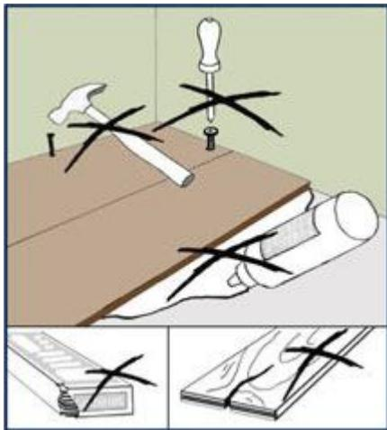
Так как ламинат укладывается плавающим способом, то есть панели ни коим образом не должны быть прикреплены к основанию, соответственно СТРОГО воспрещается жесткое крепление панелей к основанию при помощи гвоздей, шурупов, клея и т.д.
