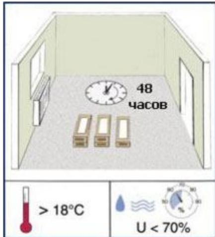
Прежде чем приступить к укладке, ламинат должен вылежаться в середине комнаты в течение 48 часов при стабильной температуре (минимум 180) и относительной влажности более 70%. Обратите внимание: все пачки ламината должны быть запечатаны. Данная процедура необходима для того, чтобы ламинат адаптировался к условиям будущей укладки.
