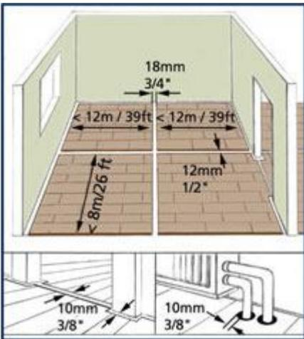
При укладке ламината большими пластами необходимо помнить, что если площадь укладываемого ламината превышает по длине или ширине 12 м и составляет более 120-150м<sup>2</sup>, необходимо предусмотреть компенсационные швы минимум 12мм шириной. В противном случае в полотне ламинат начнут образовываться щели и напольное покрытие придет в негодность.
