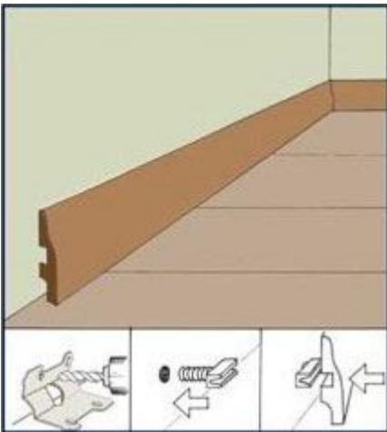
После укладки ламината можно приступать к монтажу плинтуса. Здесь приведена схема крепления плинтуса на клипсах. Обратите внимание - при использовании вентиляционных подложек (Parcolag) нижняя часть плинтуса не должна препятствовать оттоку остаточной влажности стяжки.
