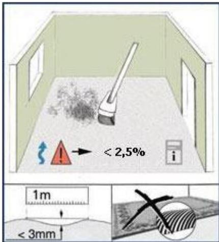
Укладка ламината допустима на линолеум, паркетную доску или иное основание при условии соблюдения требований ровности, прочности и влажности оснований для укладки ламината. Не желательна укладка ламината поверх коврового покрытия из-за эффекта "статического разряда".
