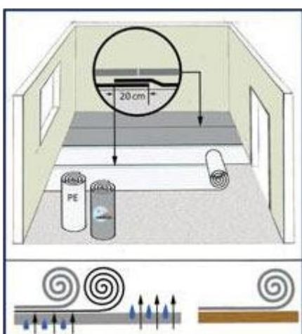
Если вы укладываете ламинат на бетонное основание, то Вам потребуетсяся полиэтиленовая пленка, для обеспечения пароизоляции от остаточной влажности Вашей стяжки. Уже после этого расстилается звукопоглощающая подложка, уже на которую осуществляется монтаж ламината.
