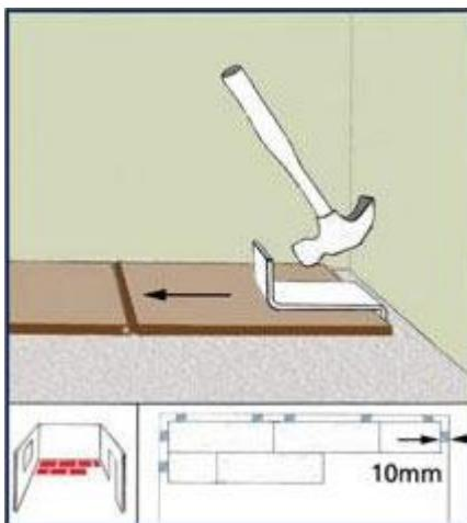
Для монтажа последней доски, примыкающей к стене используется струбцина. Она позволяет без труда осуществить соединение с предыдущей панелью.
