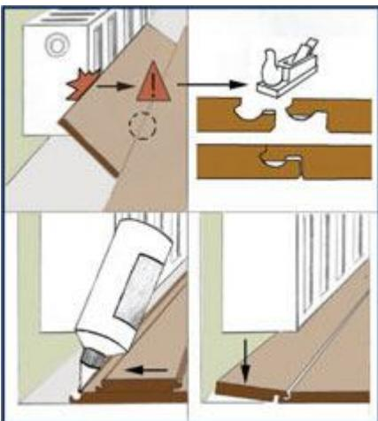
Иногда в укладке ламината возникает ситуация невозможности установки панели из-за помехи. В этом случае необходимо спилить часть замка и закрепить панель при помощи клея для ламината.
