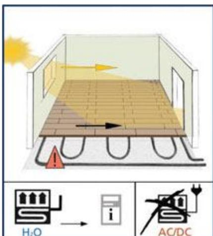
Начните укладку таким образом, чтобы свет из окна падал параллельно швам ламината. В случае перпендикулярного падения света, швы от ламината будут видны более отчетливо.
