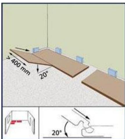
После формирования первого ряда приступаем ко 2 ряду. Обратите внимание, профессиональные укладчики всегда монтируют ламинат в половину доски, то есть вид сверху должен напоминать кирпичную кладку стены в пол кирпича, хотя в инструкциях допускается монтаж со смещением досок относительно друг друга минимум в 20 см. Укладка в "пол доски" позволяет равномерно распределить давление между панелями при расширении и сужении ламината.
