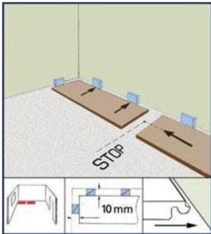
Укладка ламината начинается с формирования первого ряда из 2-ух досок, при этом устанавливаются специальные распорные клинья, обеспечивающие зазор между ламинатом и стеной от 7 до 15 мм. Данные зазоры необходимы для того, чтобы ламинату после укладки не мешала стена расширяться и сужаться. Если Ваш ламинат встал "дыбом", то очень велика вероятность, что нарушено именно это правило. Ламинат укладывается замком на себя для облегчения защелкивания панелей.
